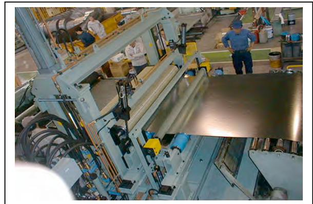
Trockene Coils, wie verzinkte oder lackierte Materialien werden von den oberen Trocken-Bändern verarbeitet.
