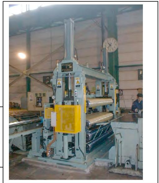
Ölige Oberflächen werden über die unteren nass-geeigneten Bänder transportiert.
